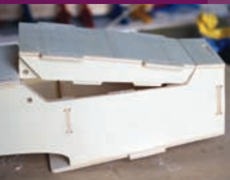
Handig acculijk in de onderkant van de romp
