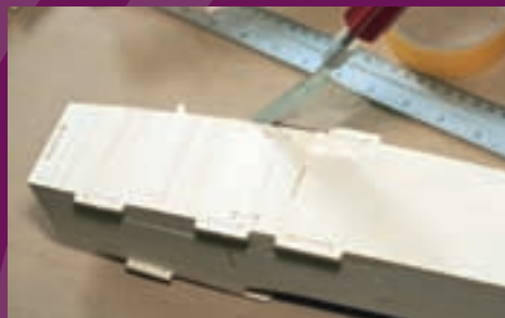
Als de lijm droog is zijn deze tabs overbodig
