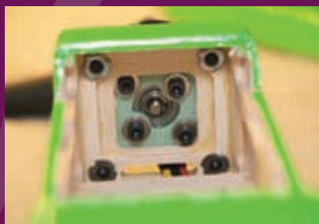
Het motorschot van binnen uit
