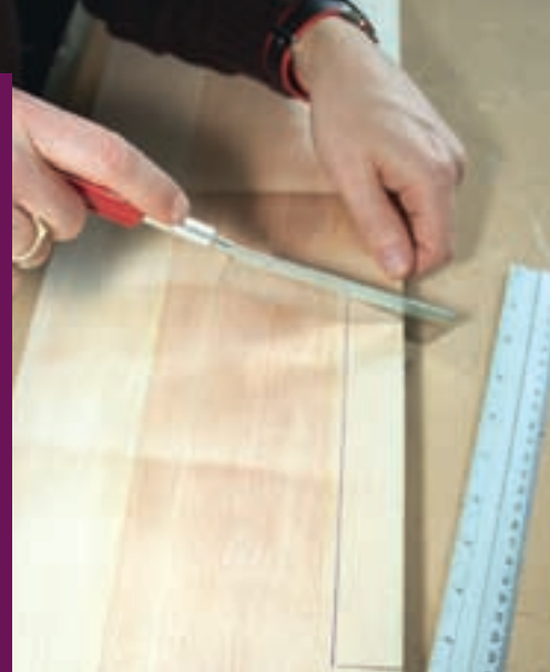
De triplex eindlijst vraagt om een scherp zaagje
