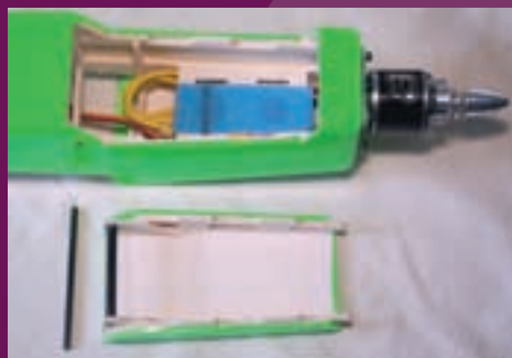
Een carbon buisje maakt het vergrendelen van het luik een stuk makkelijker
