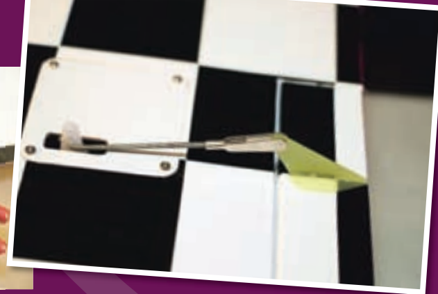
De complete aansturing van het rolroer
