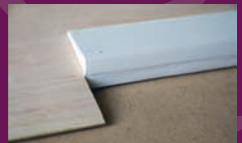
Het rolroer zit met folie vast in de vleugel
