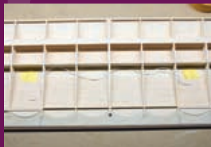
Een touwtje om later de servo draden door te voeren
