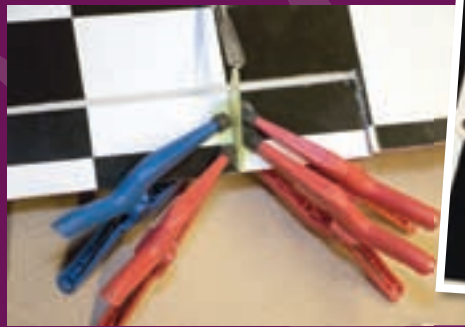
Vastlijmen van de GFK roerhoortjes
