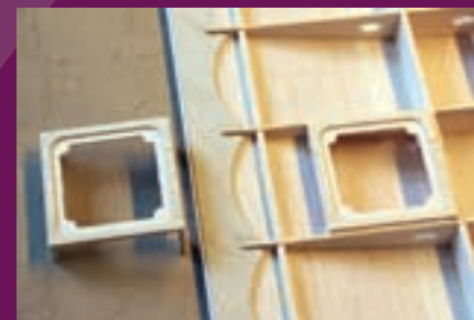
Frame voor de rolroer servo's
