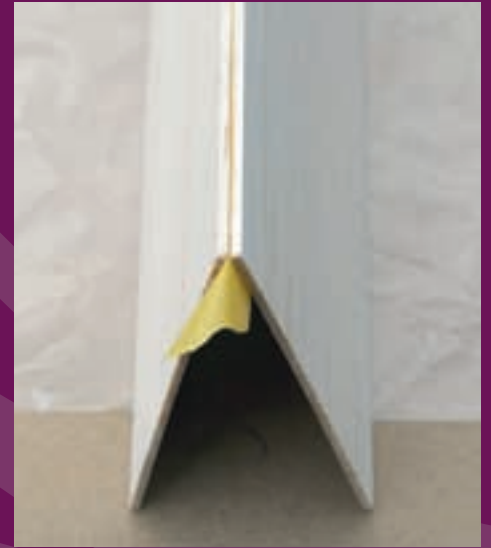
Daarna omklappen, rupsje witte houtlijm, en terugklappen
