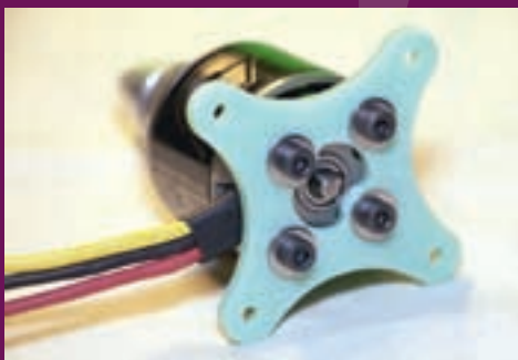
De uitstekende as is nu ingekort. De GFK motorsteun is onderdeel van de kit
