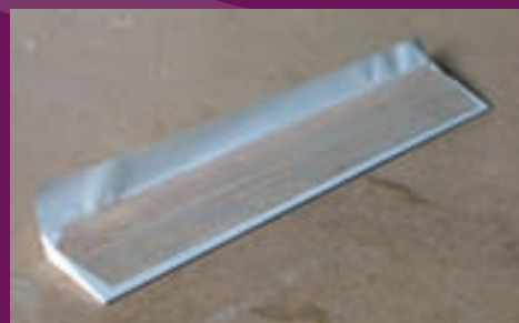
Het rolroer met extra flap als scharnierfunctie
