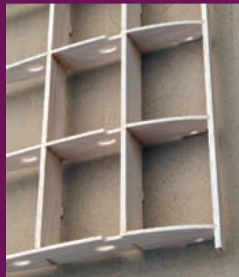
Ook de valse neuslijst past klemmend op de ribben
