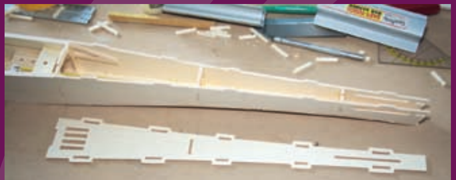
Na montage van de hoogteroer aansturing kan de romp gesloten worden
