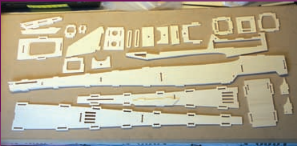
Onderdelen voor de romp. Ze passen als een 3D puzzle in elkaar
