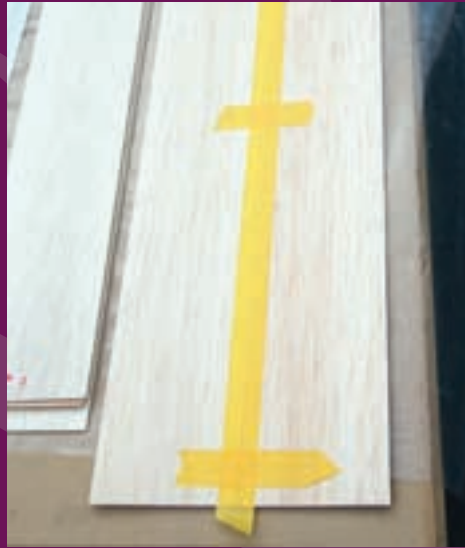
Met schildertape worden de stroken voor de beplanking tegen elkaar gedrukt
